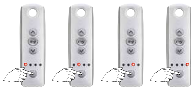
Telis 4 med solskydd programmerade för kanalerna 1 till 4
